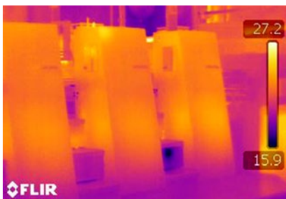
Infrarotaufnahmen einer Druckmaschine; Temperaturangaben in °C.
